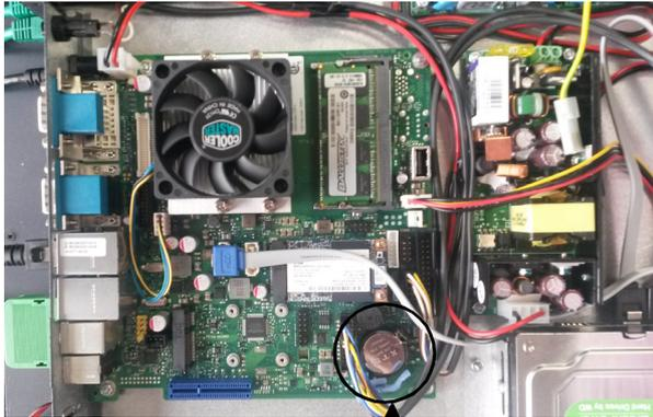
Abb. 48: Lage der Batterie bei geöffnetem Gehäuse
