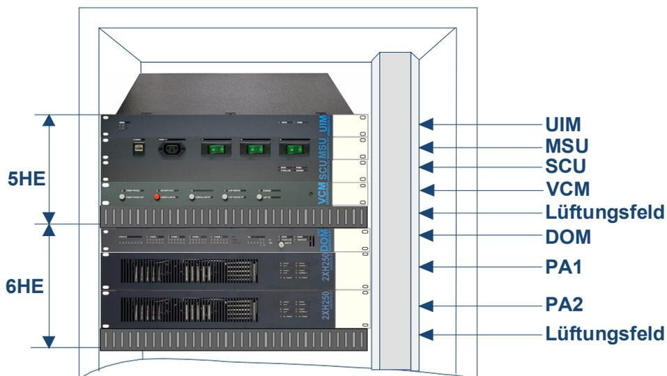
Abb. 10: Anordnung der Einbaugeräte (Beispiel)
