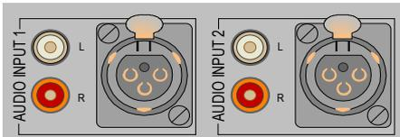
Die zwei analogen potentialfreien Audioeingänge eignen sich z.B. für den Anschluss einer externen Audioquelle (CD- / MP3-Player etc.) und sind an den XLR-Buchsen symmetrisch und an den CINCH-Buchsen asymmetrisch ausgeführt. An den CINCH-Buchsen wird das Stereosignal zu einem Monosignal gemischt.
