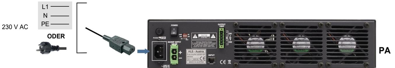
Abb. 69: 230 V AC-Anschluss direkt (Beispiel)
