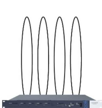
Abb. 15: Betrieb mit bis zu 4 Ringleitungen
